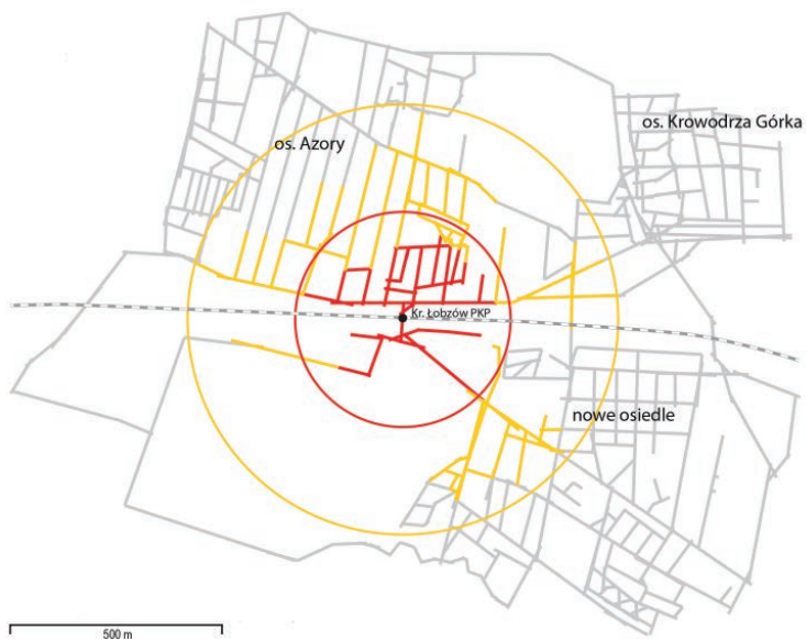
Ryc. 4. Strefa dojścia do przystanku kolejowego Kraków-Łobzów dla scenariusza B Źródło: opracowanie własne.
